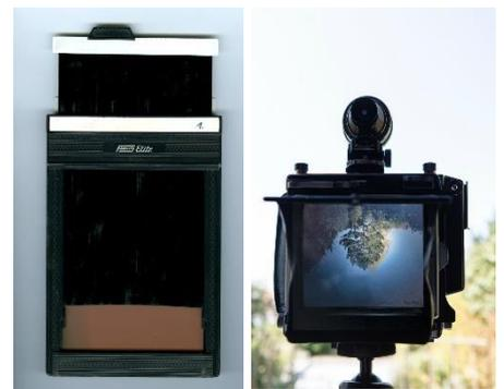
à gauche : châssis porte film avec plan film ; à droite : dépoli
